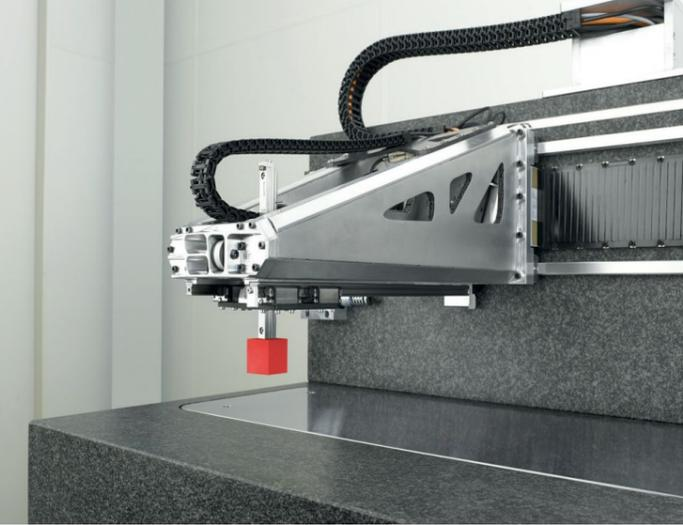
Mit konventionellen Werkstoffen und Topologieoptimierungen sind die Möglichkeiten des Leichtbaus von dynamisch bewegten Gestellbauteilen wie Schlitzen, Tischen, Verfahrportalen, Fahrständern oder Pinolen begrenzt. Deshalb bietet Rampf Machine Systems mit dem Produktbereich EPULIGHT Maschinenbauern einen ganzheitlichen Service für Baugruppen aus modernen Leichtbauwerkstoffen.
