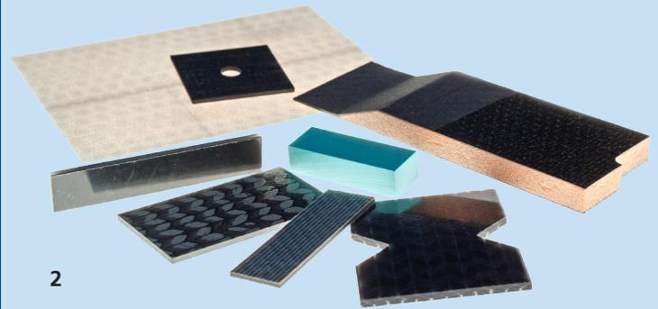
1 Positionsgenauer Zuschnitt von Probekörpern durch CAD/CAM
