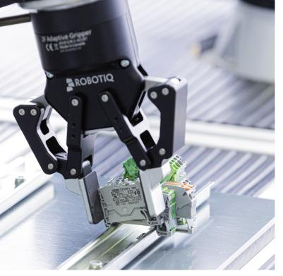
Feinfühliges Einsetzen oder Aufrasten kann effizient realisiert werden, z. B. bei der Bestückung eines Schaltschranks mit Tragschienenelementen.
