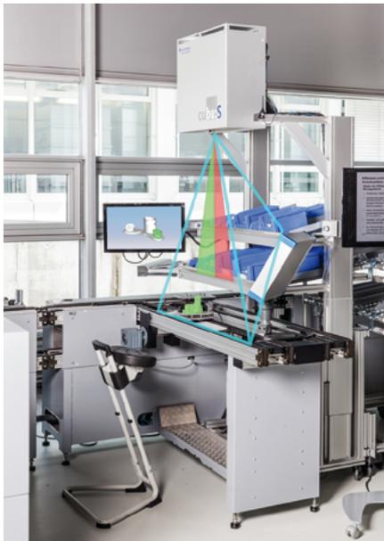
**Adaptiver Montagearbeitsplatz mit Assistenzsystem (cubu:S von Schnaithmann)**
