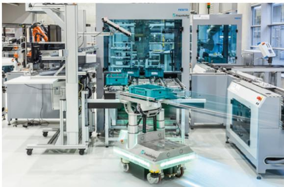
**Fahrerlose Transportfahrzeuge (FTF) ermöglichen es, Material und Werkzeuge flexibel durch die Produktion zu transportieren. Das Fraunhofer IPA entwickelt die dafür notwendige Umgebungserkennung.**
