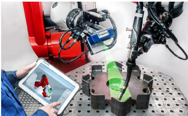
**Schweißen für Losgröße 1: Die Werkstückerkennung und Programmgenerierung erfolgt weitgehend automatisch und der Werker kann über ein Tablet Anpassungen vornehmen. (Quelle: Fraunhofer IPA/Foto: Rainer Bez)**
