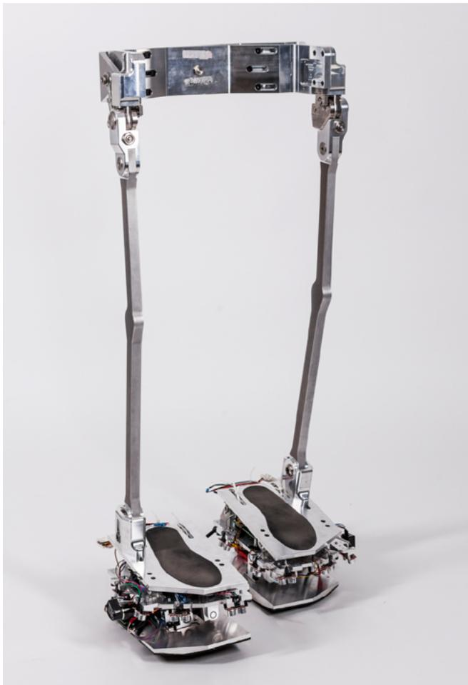
Bei »Servus RGS Adapt« haben die IPA-Wissenschaftler das bestehende System ohne Knieeinheit um Sensoren, Aktoren und eine dritte Bodenplatte erweitert.
