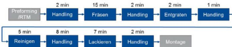
Durch die Integration aller Bearbeitungsschritte in einen einzigen Maschinengang entfallen die Handhabungsschritte. Darüber hinaus ermöglicht die Integration der Bearbeitungsschritte in einen Maschinengang die hauptzeitparallele Bearbeitung im Vergleich zum bisher seriellen Bearbeitungsprozess. Daher verkürzt sich die Durchlaufzeit.
