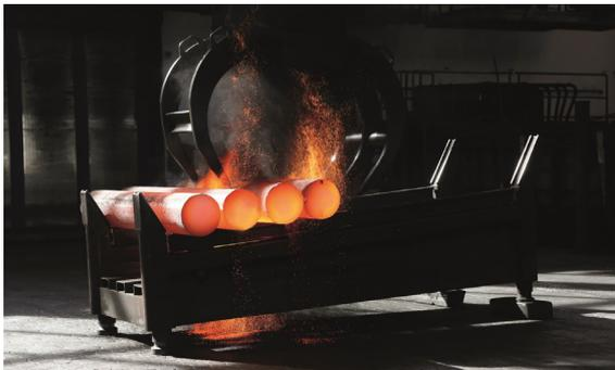
Bild 17. Entnahme des Materials aus den Graphitierungsöfen
