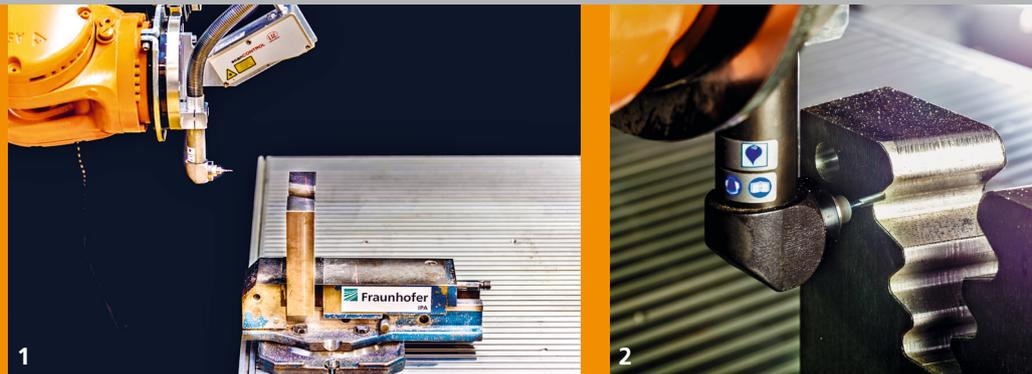
1 *Roboterbasiertes Entgratsystem zur Durchführung der Machbarkeitsuntersuchung.*
