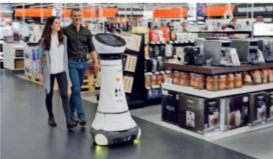
Als Roboter Paul begrüßt unser Serviceroboter der vierten Generation seit Oktober 2016 die Kunden im Saturn-Markt in Ingolstadt und begleitet sie zum gewünschten Produkt. Den Prototyp des interaktiven Roboters entwickelte das Fraunhofer IPA ursprünglich als Assistenzroboter zur aktiven Unterstützung des Menschen, z. B. in den Bereichen Haushalt, Hotel, Pflegeheim oder Krankenhaus. (Bildquelle: Saturn)
