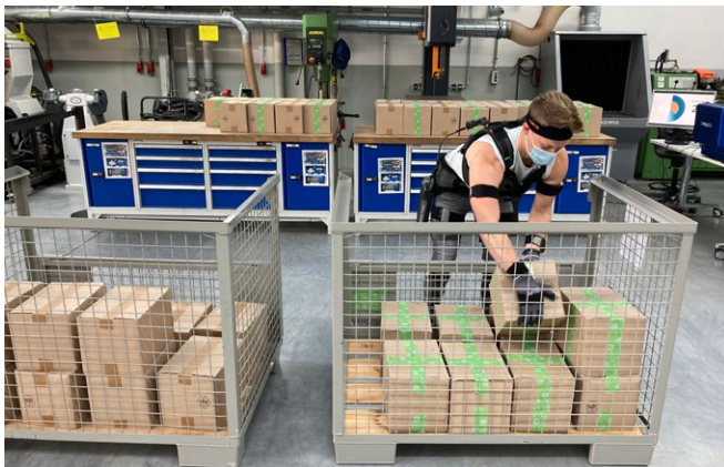
Zwei Anwendungsfälle für Exoskelette: Das Heben und Tragen schwerer Gegenstände sowie Überkopfarbeiten in der Montage.
