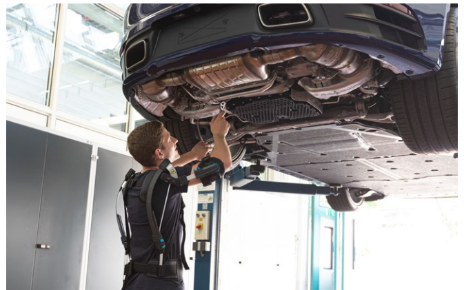
Zwei Anwendungsfälle für Exoskelette: Das Heben und Tragen schwerer Gegenstände sowie Überkopfarbeiten in der Montage.
