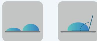
Messung der freien Oberflächenenergie von Substraten und der Oberflächenspannung von Flüssigkeiten über den Kontaktwinkel
