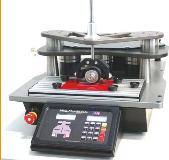
Eine bekannte Prüfmethode zur Bestimmung der Abriebfestigkeit ist das Taber-Abraser-Verfahren, welches bei vielen Anwendungen nicht ausreichend vergleichbare bzw. reproduzierbare Ergebnisse liefert. Der Grund hierfür liegt am Schleifstaub, der während des Prüfprozesses produziert wird und sich am Schleifrad festsetzt. Dieser Schleifstaub beeinflusst unkontrolliert die nachfolgenden Schleifvorgänge.
