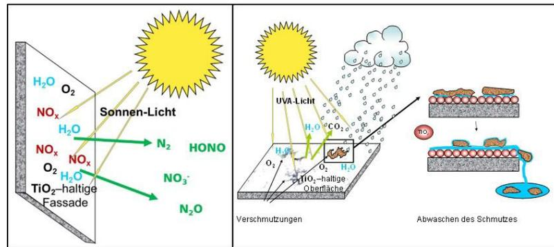
1 Schematische Darstellung der Wirkung von photokatalytisch aktiven Beschichtungen, links Schadstoffabbau, rechts Selbstreinigungseffekt.
