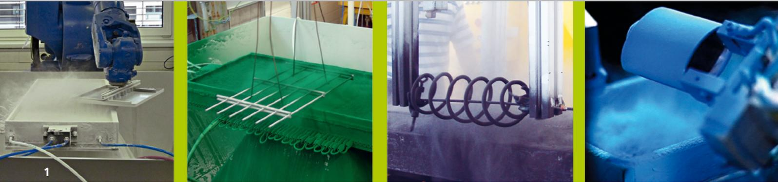
1 Anwendungsbeispiele für die sekundenschnelle pistolenlose Pulverbeschichtung mit der TransApp®-Technik.
