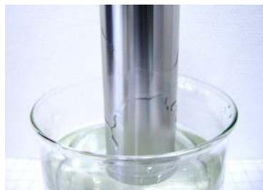
**Mobilgerät** zur Bestimmung der Benetzung mittels **Kontaktwinkel-Methode**<sup>1</sup>
