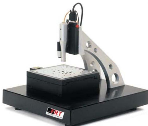
Berührungslose Erfassung der Oberflächenrauheit und der Oberflächentopographie mittels der **Laser-Scanning-Mikroskopie**. Mithilfe der LSM werden durch die Kombination von Farbbild und hochaufgelöster Laser-Topographiemessung ein hochdetaillierteres 3D-Abbild des Messobjekts erzeugt<sup>2,4</sup>
