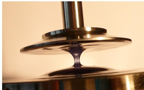
Bestimmung rheologischer Eigenschaften von Lacken und anderen flüssigen Medien mit der **Oszillationsrheometrie**, Bestimmung der Langzeitstabilität von Dispersionen<sup>1,2</sup>
