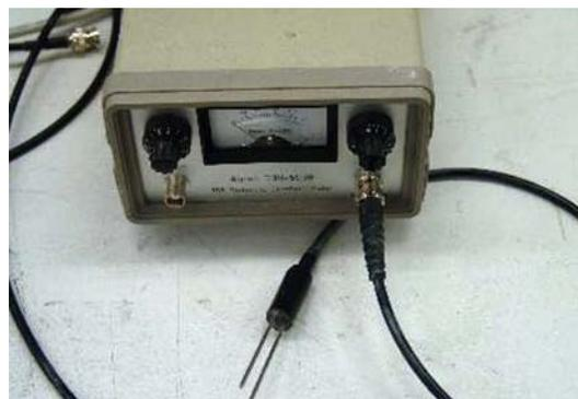
Bestimmung des **triboelektrischen Aufladungs-verhaltens** ( $q/m$ ) über das IQT-Messverfahren<sup>7</sup>
