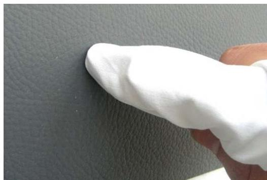
Bestimmung mit dem **Kreidungsgerät**<sup>2,5</sup>
