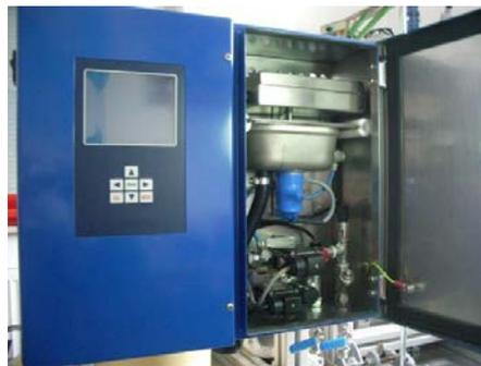
Onlinemessung der **Dichte von Flüssigkeiten** z.B. zur Bestimmung des Festkörpergehaltes<sup>1,7</sup>
