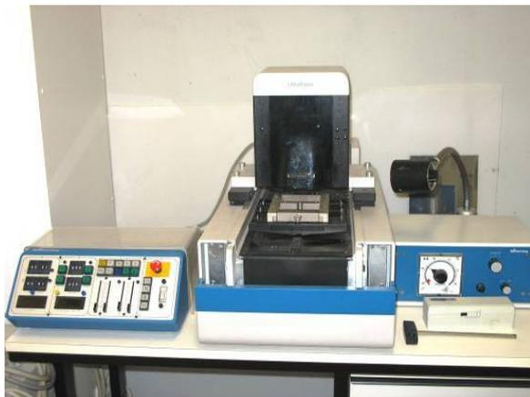
Analyse von Lackoberflächen und Beschichtungen mit der **Infrarotmikroskopie**<sup>1</sup>
