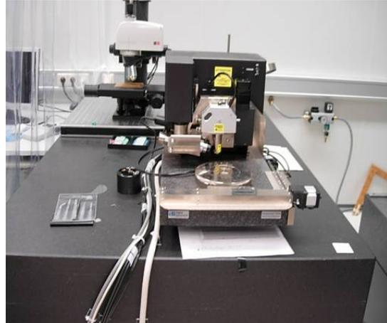
Mikroskopische Untersuchung von Lackierfehlern nach Schichtabtrag mit dem **Mikrotomschnitt-Verfahren** und anschließende Analyse der Filmabschnitte und freigelegten Oberflächen<sup>1,2</sup>
