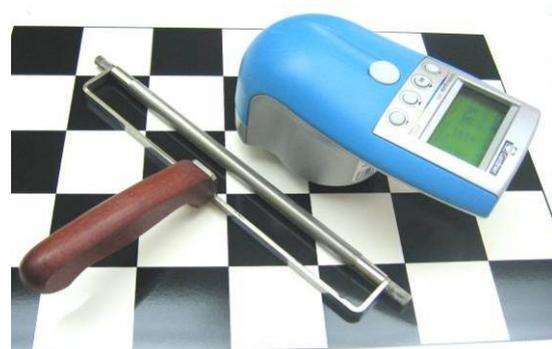
Bestimmung des **Kontrastverhältnisses** von hellen Beschichtungen bei einer festgelegten Ergiebigkeit<sup>2,5</sup>
