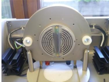
**Wasserdampfpermeationsrate** von Folien und freien Beschichtungsfilmen<sup>2</sup>
