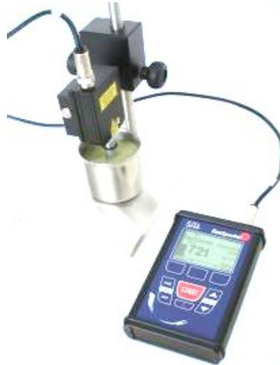
Onlinemessung der **Oberflächenspannung von Flüssigkeiten** z.B. zur Bestimmung der Tensid-konzentrationen<sup>7</sup>
