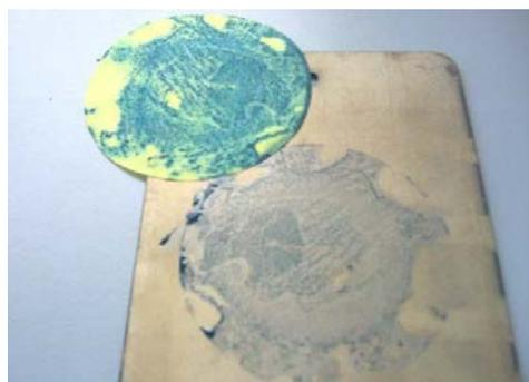
Nachweis von nicht vorbehandelten Eisen-Zonen an Vorbehandlungsschichten, z.B. Zinkphosphatierungen, mittels **Kupfersulfat-test** (Abscheidung von elementarem Kupfer auf freiliegender Grundwerkstoffoberfläche)<sup>5</sup>
