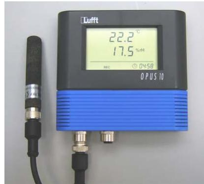
Bestimmung **der Temperatur, Luftfeuchte, Taupunkt, Luftgeschwindigkeit, Luftdruck, Differenzdruck**<sup>5, 6</sup>
