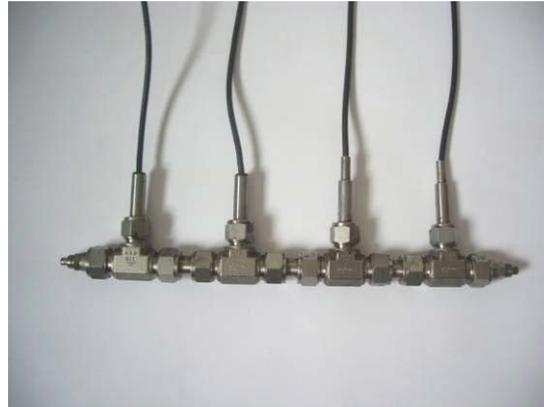
Onlinemessung des **Licht-Brechungsindex in Flüssigkeiten** z.B. zur Bestimmung der organischen Lösemittelkonzentration<sup>7</sup>
