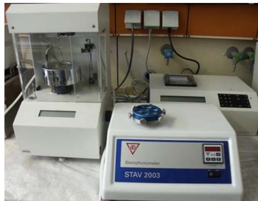
Bestimmung der **Oberflächenenergie** von Pulverlack-Schmelzen<sup>2</sup>
