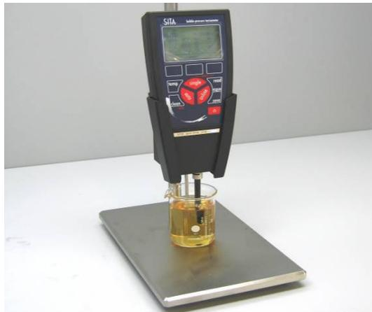
Bestimmung der **Oberflächenenergie** von Substratoberflächen der **Oberflächenspannung** von Flüssigkeiten, **Benetzung von Lacken** auf Substraten und der **Adhäsionsarbeit**  $W_{ad}$ <sup>1,2</sup>
