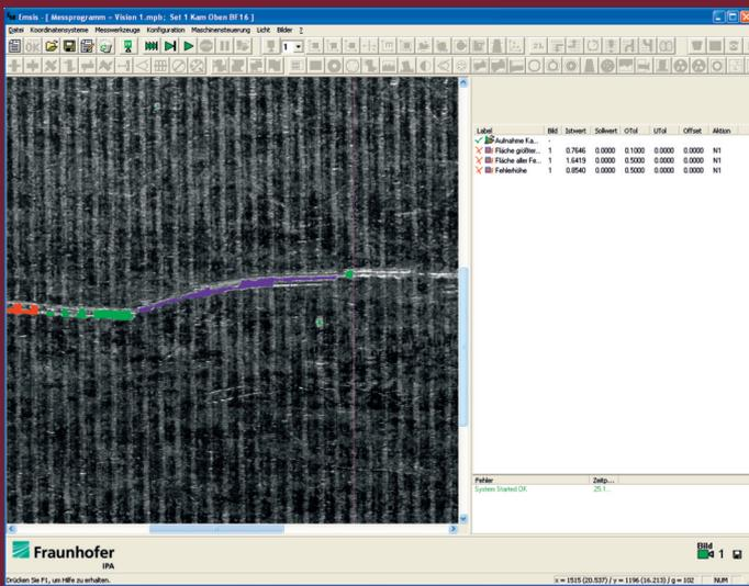
in unbekanntem Oberflächen zu erkennen. Unter der Voraussetzung, dass die Defekte nur einen kleinen Teil der gesamten Oberfläche einnehmen, werden diese als auffällige Abweichungen vom Hintergrund wahrgenommen. Dieses Vorgehen wird von der Prüfsoftware nachgeahmt. Bei der Analyse der Oberfläche wird ein Modell der Oberflächenstruktur erzeugt, das lokale Störungen ausblendet.
