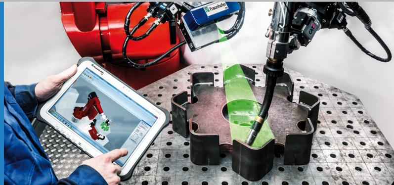
1 *Intuitive Programmierung mit den Fraunhofer IPA Sensorikkomponenten.*
