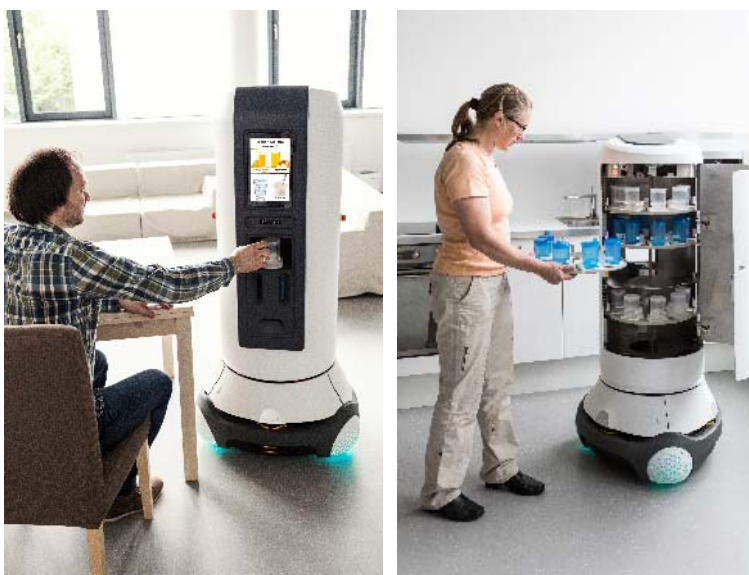
Bild: Robotischer ServiceAssistent beim Anreichen eines Getränks, einfache Befüllung mit Tabletts
