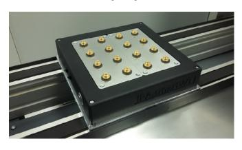
Der intelligente Werkstückträger »IPA.smartWT« erfasst qualitätsrelevante Logistikund Prozessdaten und übermittelt sie drahtlos nach außen. (Quelle: Fraunhofer IPA)
