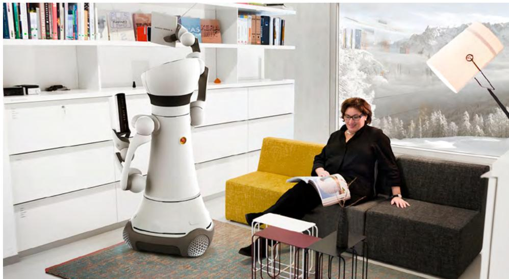
**Die Weiterentwicklung des Care-O-bot für neue Anwendungsfelder erfolgt weiterhin am Fraunhofer IPA. Das Ziel: Der Assistenzroboter soll Menschen mit körperlichen Einschränkungen ein selbstbestimmtes Leben in ihren eigenen vier Wänden ermöglichen. (Quelle: Fraunhofer IPA)**
