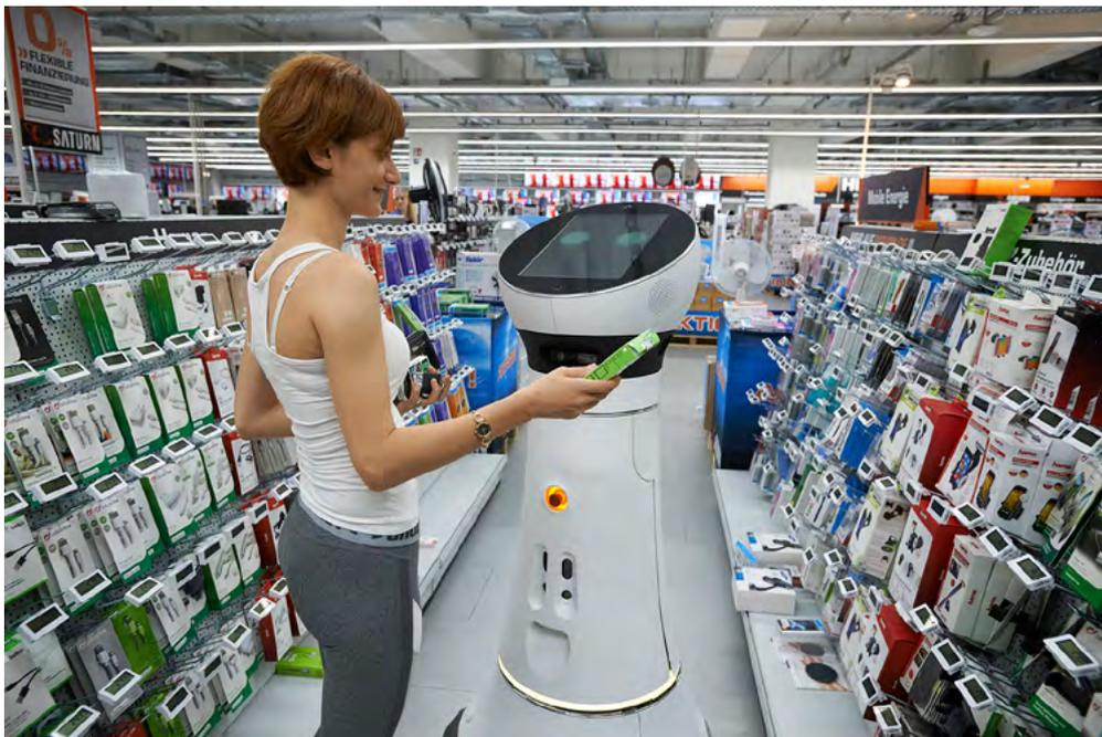
Der Care-O-bot ist speziell für die Interaktion mit und die Unterstützung von Menschen in Alltagsumgebungen geeignet und kann aufgrund seiner Modularität einfach an unterschiedliche Aufgaben angepasst werden. So begrüßt er als »Paul« beim Elektronik-Einzelhändler »Saturn« die Kunden und führt sie durch das Geschäft.
