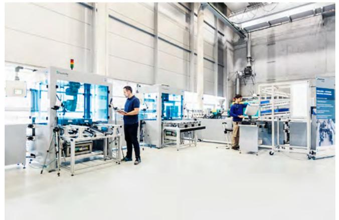
**Mit intelligenten Kameras und einem Maschinensteuerungskonnektor erkennt die »Smarte Systemoptimierung« des Fraunhofer IPA Produktionsfehler und deren Ursachen. (Quelle: Universität Stuttgart IFF/Fraunhofer IPA Foto: Rainer Bez)**
