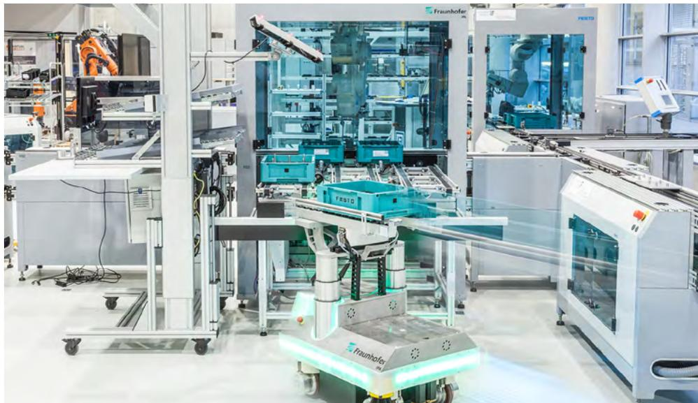
Die Cloud-basierte Navigationstechnologie, entwickelt am Fraunhofer IPA, macht den Einsatz von fahrerlosen Transportsystemen verlässlicher, flexibler und effizienter. (Quelle: Universität Stuttgart IFF/Fraunhofer IPA
