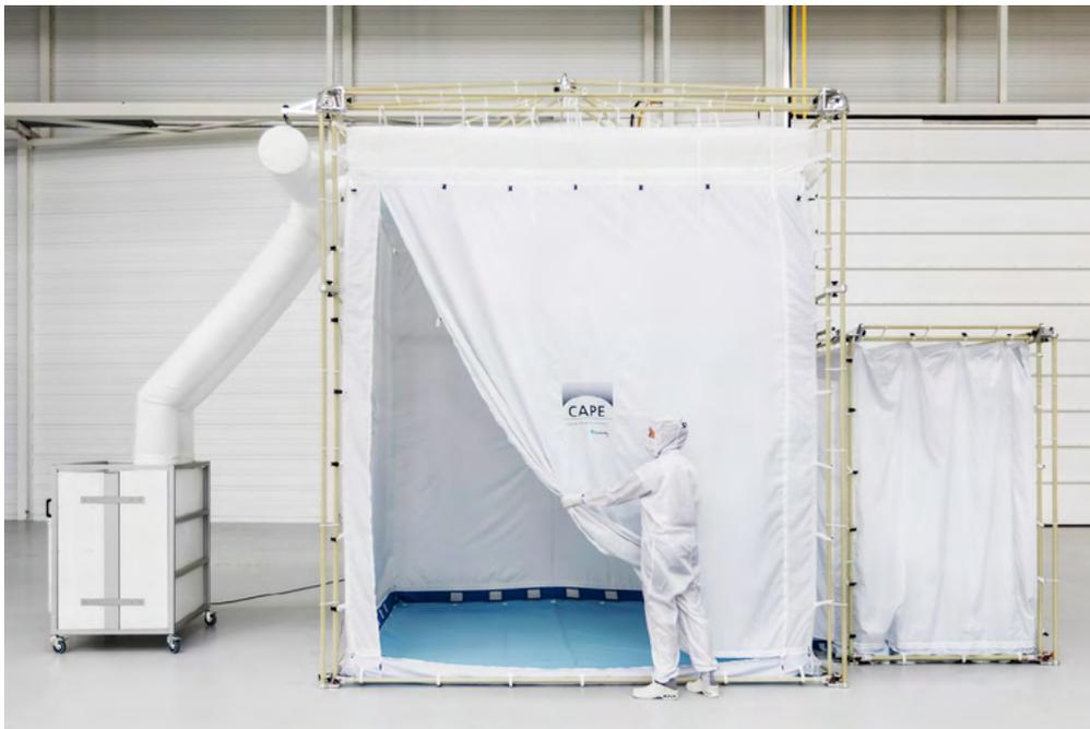
»CAPE®« ist flexibel wie ein Zelt und ermöglicht eine hochreine Fertigungsumgebung bis zur ISO-Klasse 1. (Quelle: Fraunhofer IPA, Foto: Rainer Bez)
