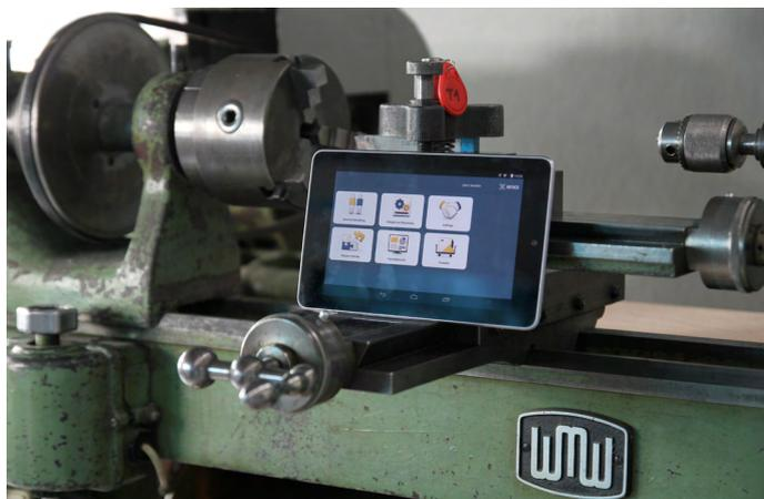
**Wissenschaftler haben eine alte Drehmaschine mit Sensoren ausgerüstet, die über einen Manufacturing Service Bus verfügbar gemacht werden.**
