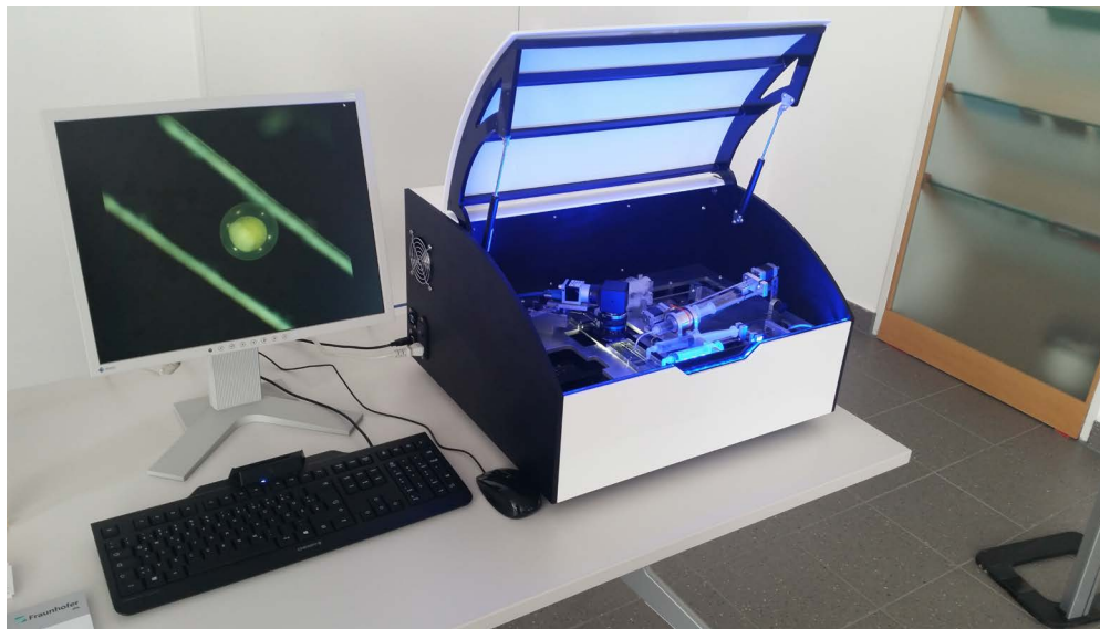
Prototyp des Fischei-Sortierers. Der Apparat erkennt mithilfe eines Kamerasystems und Machine-Learning-Algorithmen, ob die Eier von Zebrafischen befruchtet sind oder nicht und sortiert diese entsprechend. Quelle: Fraunhofer IPA
