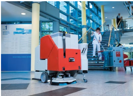
Der Reinigungsroboter mit Nassreinigungsmodul beim Praxistest in einem Krankenhaus.
