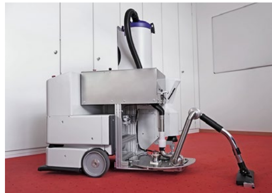
Der Reinigungsroboter mit dem Modul zum Staubsaugen bei der Erprobung in den Büroräumen der Dussmann-Hauptverwaltung in Berlin.
