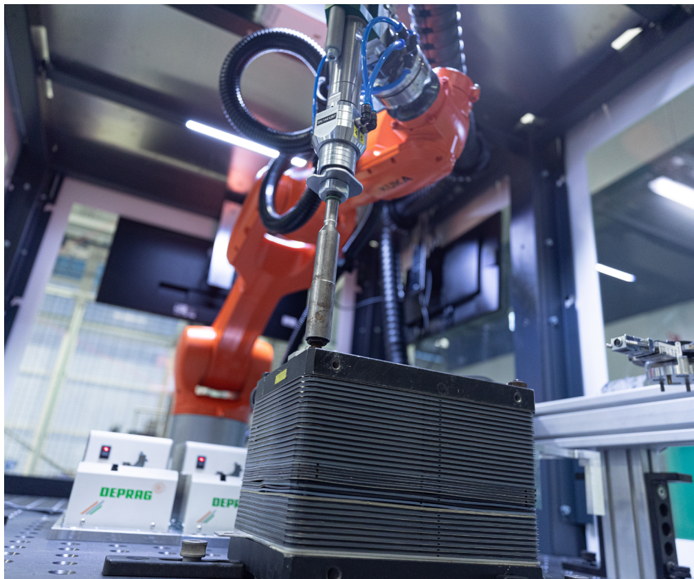
Ein Industrieroboter demontiert einen Elektrolyseurstack.
