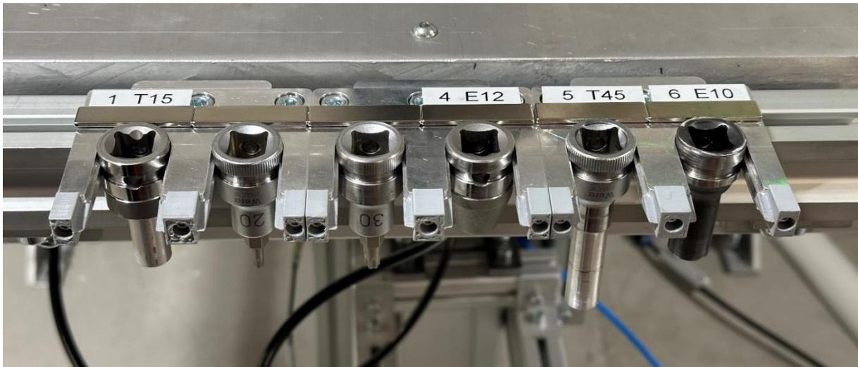
Abbildung 94: Bitnusswechselsystem für automatisierte Werkzeugwechsel.
