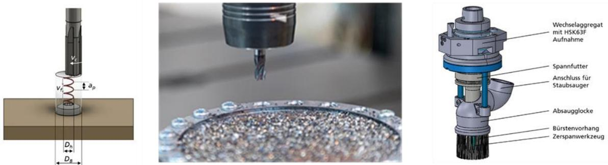
Abbildung 33: Zirkularfäsen (links); Trennprozess (Mitte); Absaugsystem (rechts).
