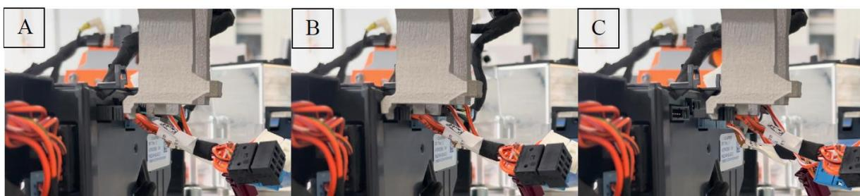
Abbildung 39: Beispielhafte Demontagesequenz eines Steckers ohne Widerhaken.
