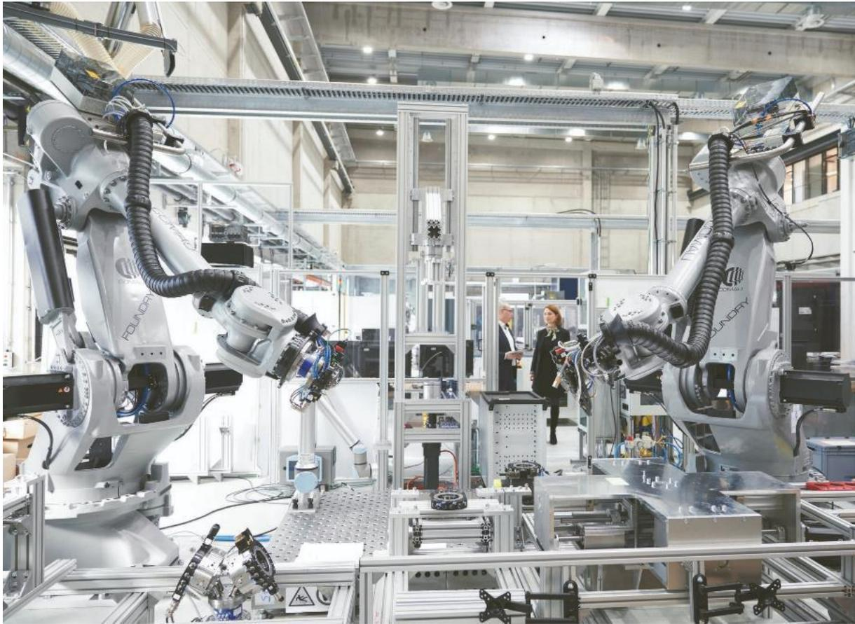
Abbildung 57: Aufgebaute Roboterzelle für die Demontage von Batteriemodule.
