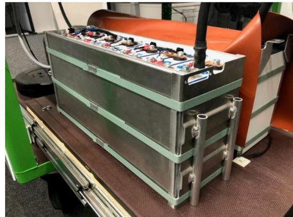
Abbildung 87: Prototyp der zweiten Version des prismatischen Batteriemoduls.
