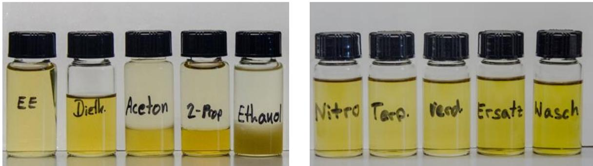
Abbildung 90: Löslichkeitsproben von Getriebeöl in verschiedenen Lösungsmitteln.
