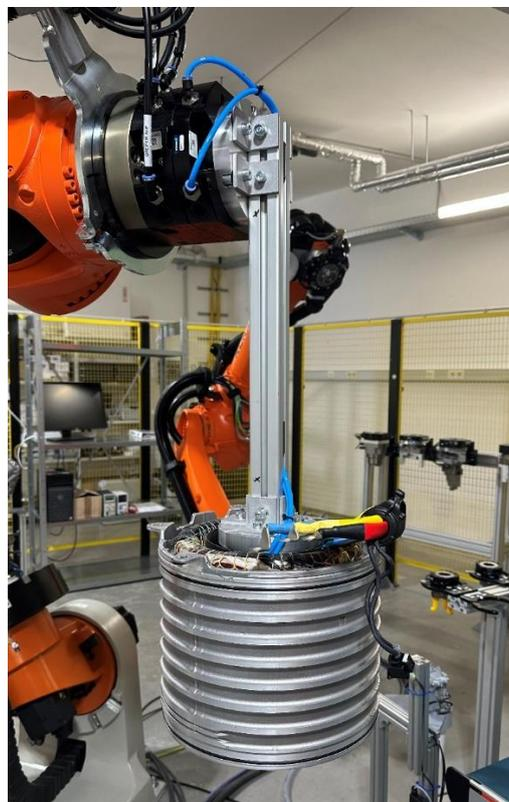
Abbildung 92: Demontierter Stator am Statorgreifer.
