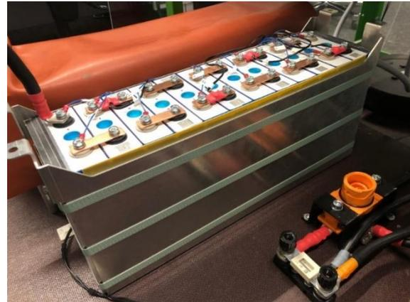
Abbildung 85: Prototyp des prismatischen Batteriemoduls der ersten Generation.
