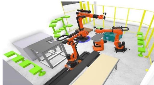
Abbildung 121: Virtuelle Anlage zur Demontage von E-Motoren (CUTEC).
