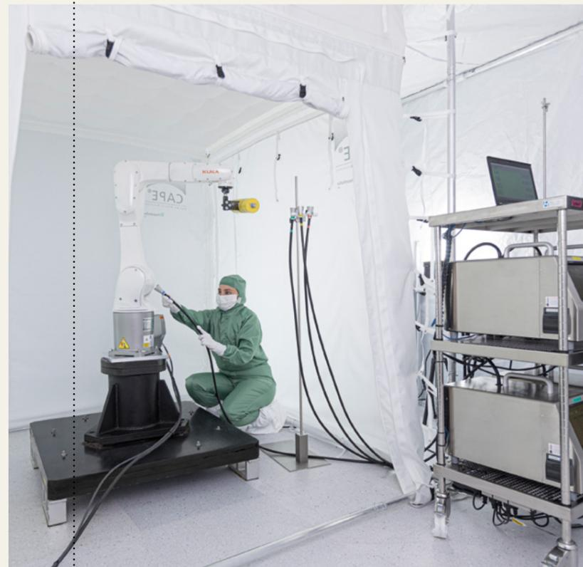
untersucht. Im Ergebnis lässt sich feststellen, dass es entsprechend der konstruktiven Gestaltung und der Werkstoffauswahl erhebliche Unterschiede zwischen der Partikelfreisetzung im Reinraum gegenüber dem Trockenreinraum gibt. In den besten Fällen wurden gleiche Qualitäten in Reinraum und Trockenreinraum festgestellt. In den schlechtesten Fällen ist die Partikelfreisetzung im Trocken-Reinraum bis zu 1000-fach höher.
