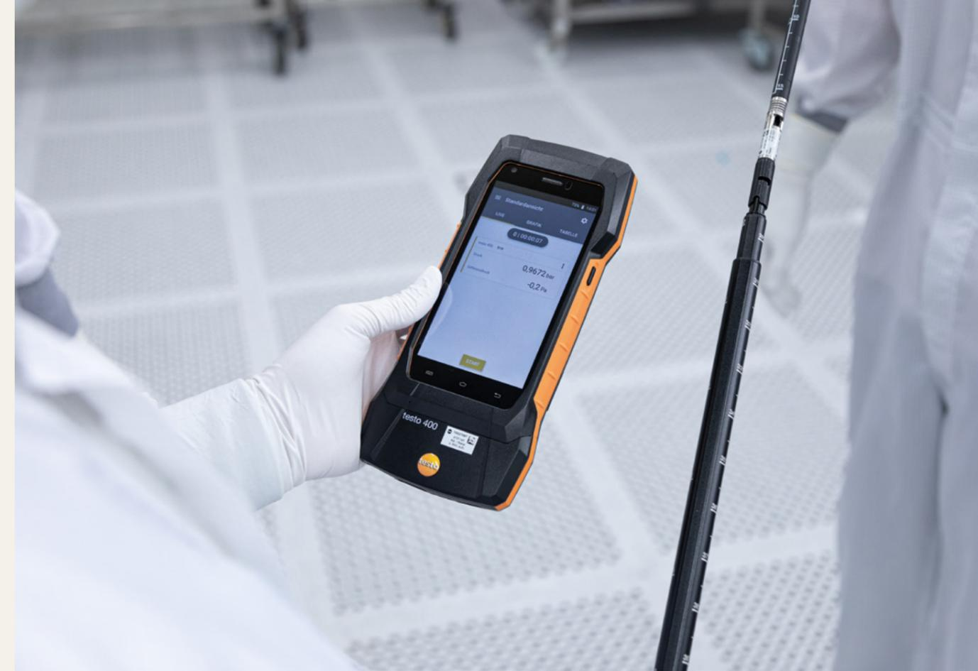
Partikelmessung mithilfe eines optischen Partikelzählers
