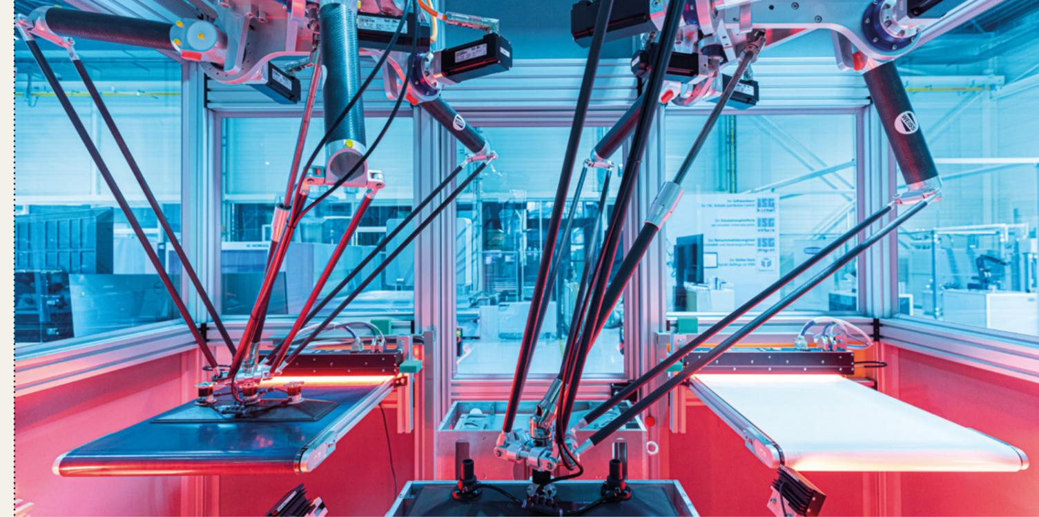
Vollkommen automatisiert und in Sekundenschnelle stecken zwei Deltaroboter eine Brennstoffzelle.
