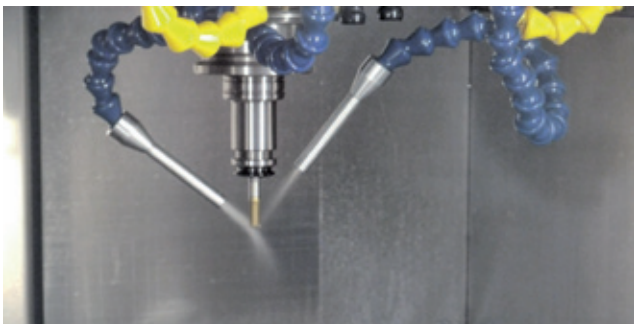
Abbildung 22: Äußere Kryokühlung: Kaltaerosoles Schmiermittel wird außen auf das Werkzeug gesprüht 31
