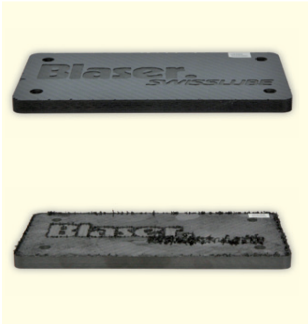
Abbildung 19: Bearbeitungsergebnisse bei der Zerspantung mit (oben) und ohne (unten) Kühlschmierstoff 25
