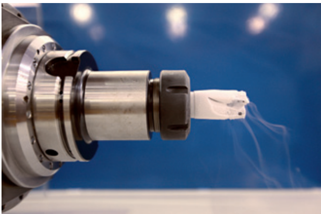
Abbildung 23: Innere Kryokühlung: Kühlmittel wird intern zugeführt, wobei sich auf der Oberfläche des Werkzeugs Eiskristalle gebildet haben 32
