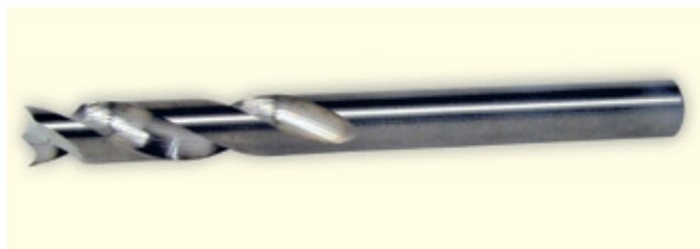
Abbildung 17: Bohrer mit speziell für Faserverbundwerkstoffe geschliffener Spitze 4
