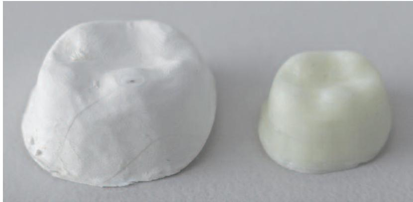
*Additiv gefertigter Grünkörper aus Zirkonoxid (links); fertiges Bauteil nach dem Sintern (rechts).*
