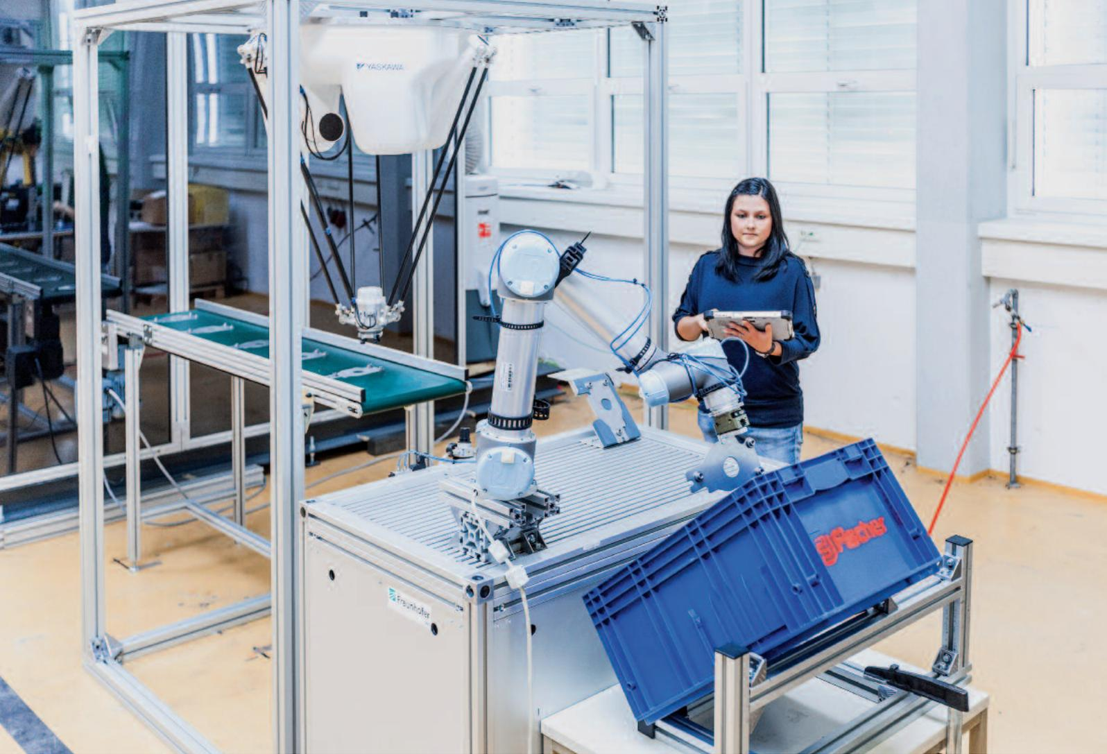
*Im Rahmen von ReApp hat das Fraunhofer IPA einen Demonstrator für das »Picken vom Band« entwickelt.*
