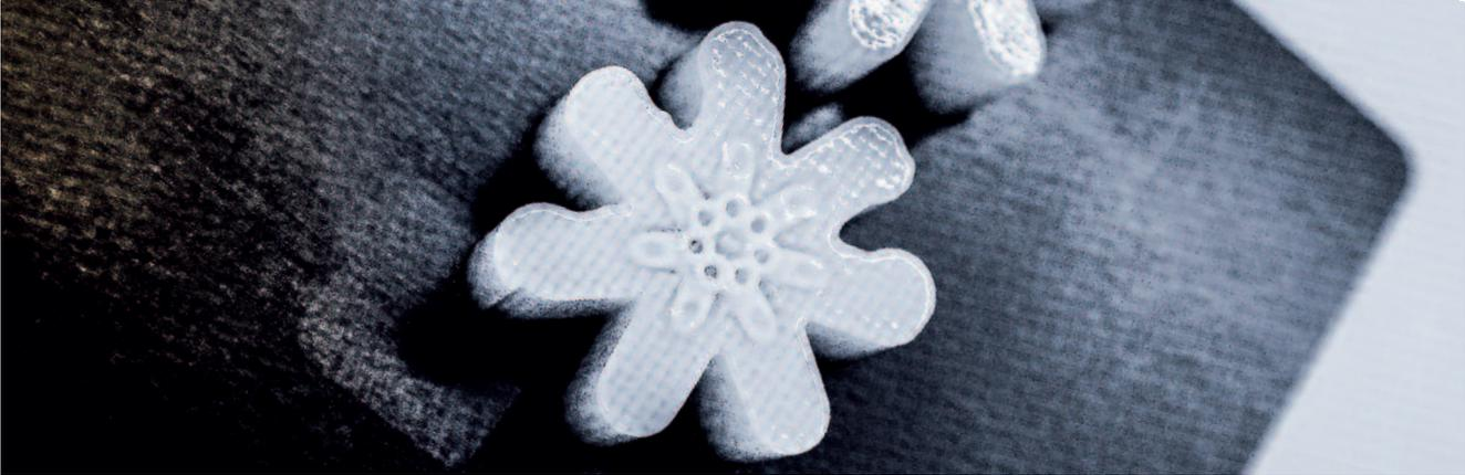
*Gefäßstruktur während des Fertigungsprozesses; wachsartiges Supportmaterial umgibt die Struktur zur Stabilisierung während des schichtweisen Aufbaus.*
