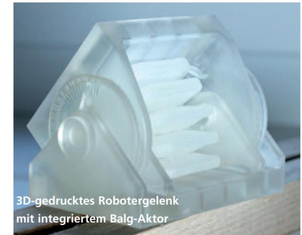
**3D-gedrucktes Robotergelenk mit integriertem Balg-Aktor**
