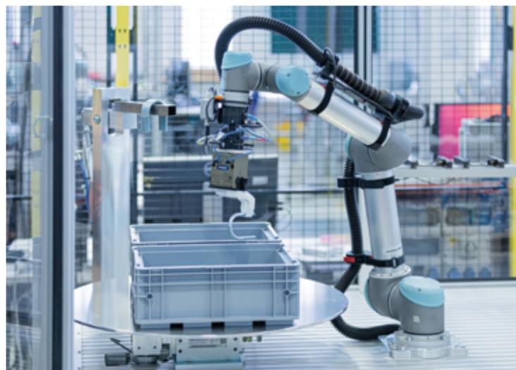
*Der »AI Picking«-Demonstrator zeigt die KI-gestützte Vereinzelung von Werkstücken durch einen Roboter.*
