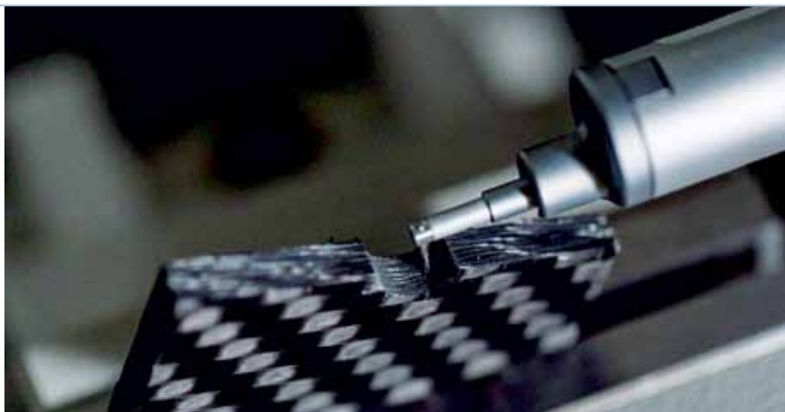
Bild 2. Oberflächen- und Rauheitsmessung einer bearbeiteten CFK-Struktur mit herkömmlichen Tastschnittverfahren
