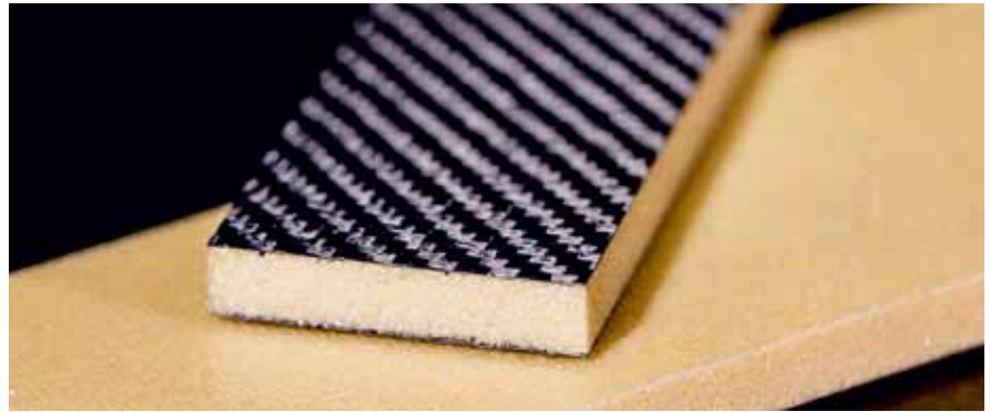
Bild 1. Verbundwerkstoff aus Schaumstoff und kohlenstofffaserverstärktem Kunststoff
