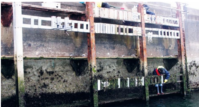
Versuchsstation auf Helgoland im Rahmen der Entwicklung nanoskaliger Korrosionsschutzpigmente
