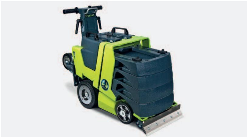
Das Ablösen und Entfernen von großflächig verklebten Bodenbelägen unterschiedlicher Materialien stellt für das bodenlegende Gewerbe eine Herausforderung dar. Für diese Aufgabe werden sogenannte Stripper eingesetzt. Durch eine Klinge, die in Fahrtrichtung stößt und in Querrichtung oszilliert, wird der Belag vom Boden abgehoben. Hierbei spielen die Schlag- und Antriebsleistung des Motors sowie die Masse des Strippers die entscheidende Rolle für die Effizienz.
