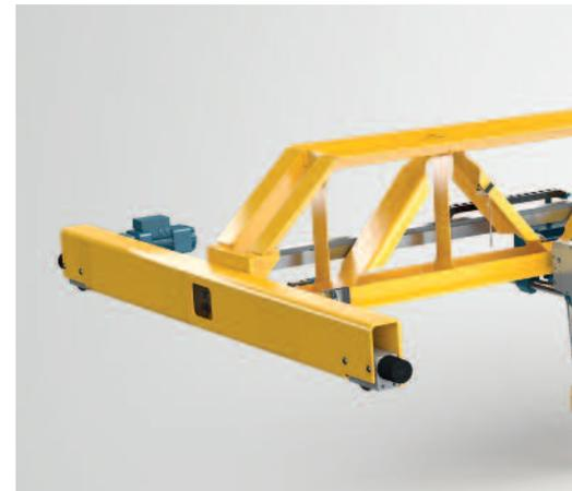
Weniger Eigengewicht, schnelle Lastberuhigung, lange Lebensdauer – mit dem Demag V-Profilkran revolutioniert Terex Material Handling das Lastenhandling und setzt einen neuen Standard in der Branche. Durch seine innovative, ressourcenschonende V-Bauweise wird Stahl nur da eingesetzt, wo er erforderlich ist. Hoch beanspruchte Teile sind zusätzlich versteift – ähnlich dem bionischen Prinzip beim Knochenaufbau.
