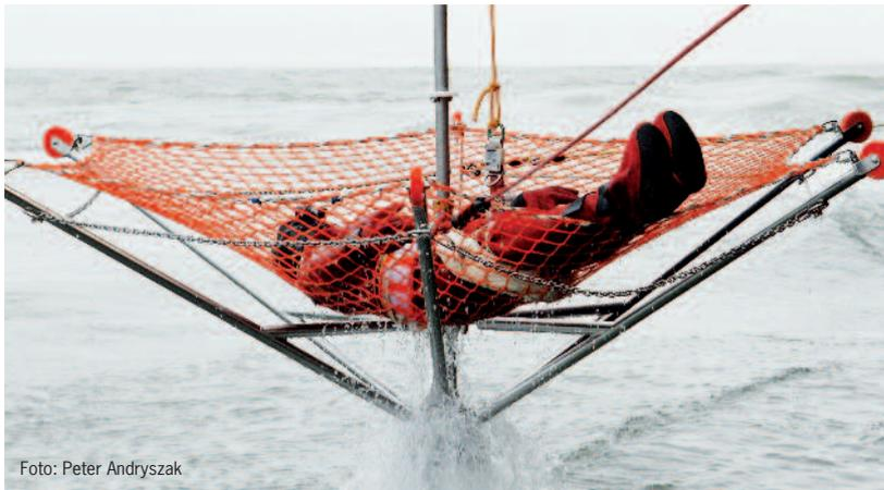
Vor dem Hintergrund schwerer Unfälle mit Todesfolge auf See wurde bereits 2006 von der International Maritime Organisation (IMO) die Entwicklung eines leistungsfähigen Rettungsgerätes gefordert. Die vertikale Bergung von Personen aus dem Wasser, insbesondere bei Unterkühlung und Erschöpfung, birgt die Gefahr des Bergungstodes.
