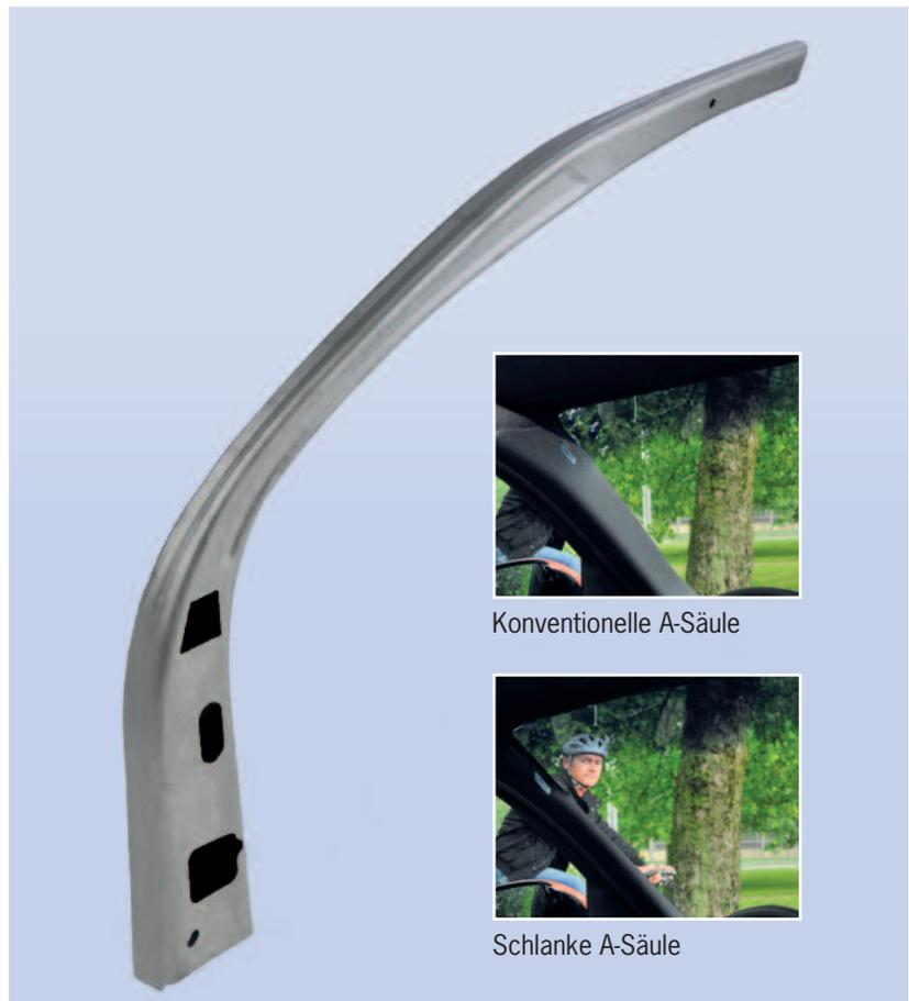
Die A-Säulen eines Pkw tragen als wesentliche Bestandteile der Karosseriestruktur maßgeblich zur Stabilität des vorderen Bereichs der Fahrgastzelle und damit zur passiven Crashesicherheit bei. Steigende strukturmechanische Anforderungen haben die Breiten der A-Säulen bei aktuellen Modellen im Vergleich zu ihren Vorgängern deutlich anwachsen lassen. Die damit zunehmende Verdeckung des Fah-
